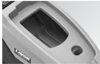
Depósito de solución de polietileno, moldeado en rotacional, de grandes dimensiones y fácilmente inspeccionable, resistente a los golpes y a los ácidos
